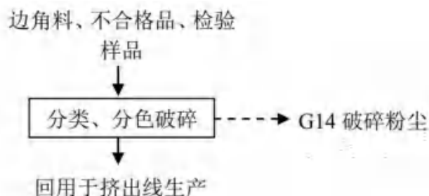
图 2.8-6 配套粉碎回收工艺流程及产污环节
